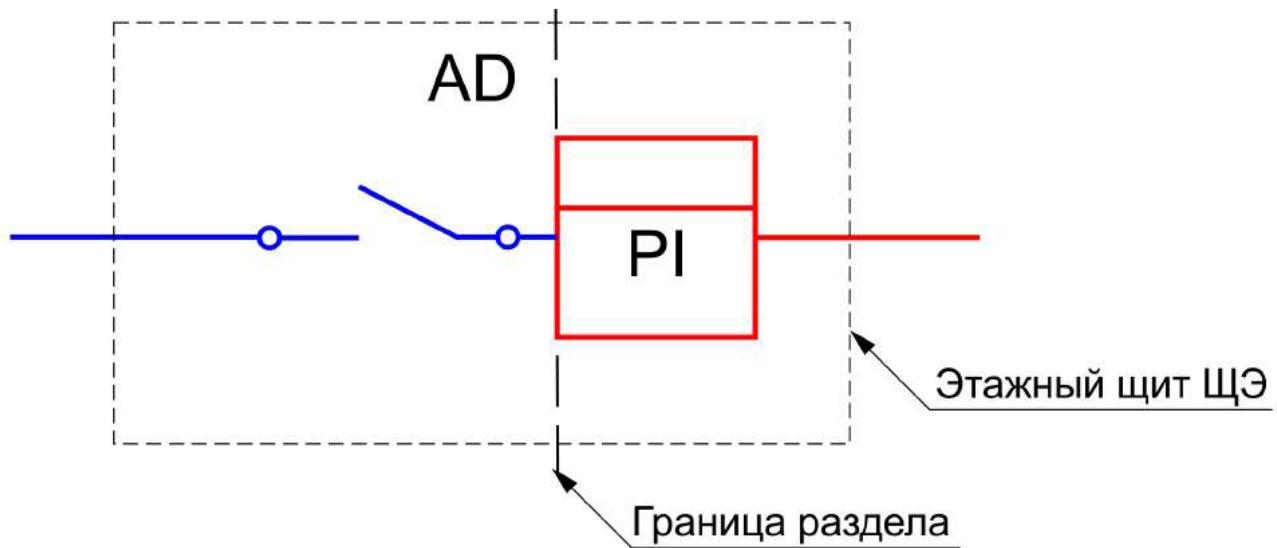
AD – вводной автоматический дифференциальный выключатель. PI – узел учета электрической энергии.
